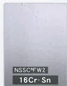
16Cr-Sn(左)と18Cr-8Ni(右)で比較 (塩水環境の対錆性は、SUS304と同等)
