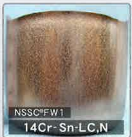
14Cr-Sn-LC,N(左)と18Cr-LC(右)で比較 (年輪状模様が少ないので加工後の手入れが軽減)
