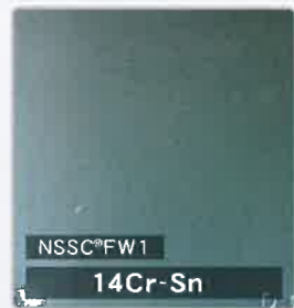
14Cr-Sn(左)と14Cr(右)で比較 (Sn添加により錆発生を抑制)
